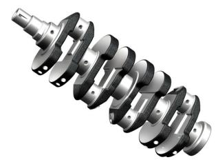
曲轴主要由碳素结构钢或球墨铸铁等材料制成,是发动机的主要旋转件,装上连杆后,可将活塞的直线往复运动变成旋转运动。目前,我们常见的汽油发动机最高转速达 6000r/min 以上,这就对曲轴的加工工艺包括位置度、圆度、各档曲轴孔中心的直线度及表面粗糙度等提出了更为严格的要求。
